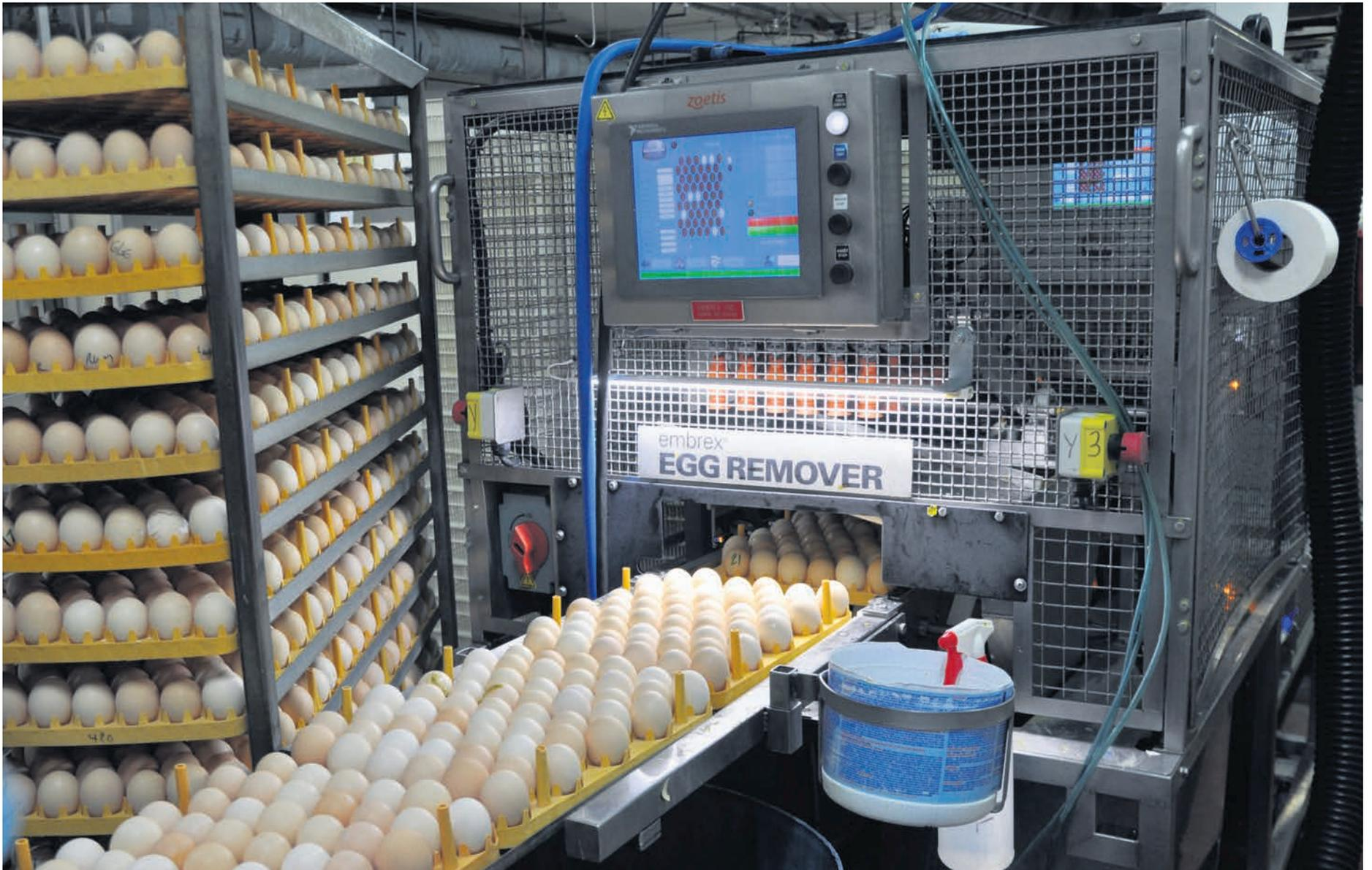
La machine détecte et retire les œufs d'incubation qui présentent des défauts et procède aux vaccins dans l'œuf avant l'éclosion, ce qui évite de devoir vacciner les poussins. Elle traite jusqu'à 168 œufs à la fois pour un total de 45 000 à l'heure. Un jet de chlore sur chaque aiguille prévient la contamination entre chaque vaccin.
